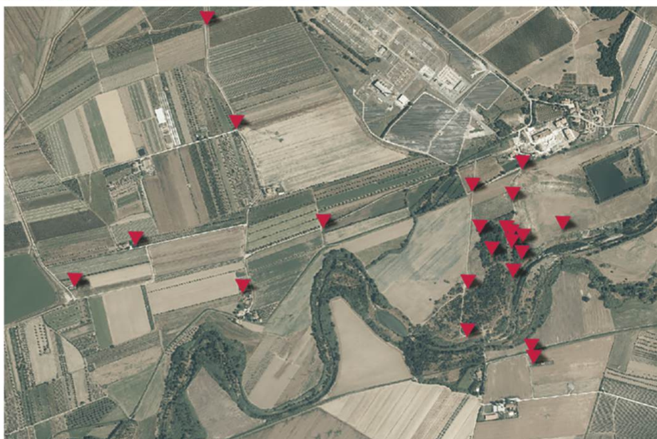
Il posizionamento dei piezometri per misurare il carico idraulico delle falde
